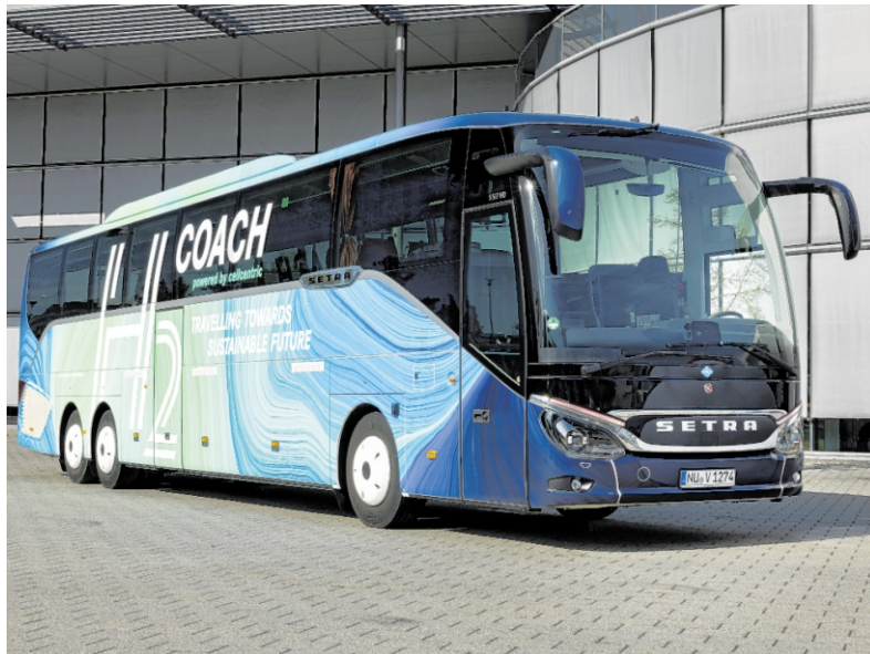
Der „H 2 Coach“ mit Brennstoffzellen-Antrieb. Er soll laut Unternehmen mindestens 800 Kilometer mit einer Tankfüllung schaffen.
